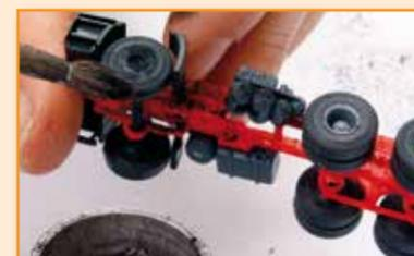
Als Basis für eine schöne Alterung mit Pulverfarben wird Schwarz aufgetragen. Bei Fahrzeugen ist es sinnvoll, die Alterung fortschreitend mit dem Zusammenbau durchzuführen.
