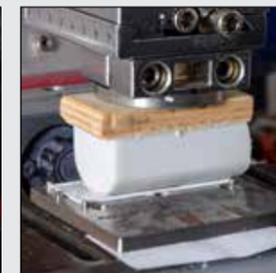
...anschließend wird das Bauteil bedruckt.
