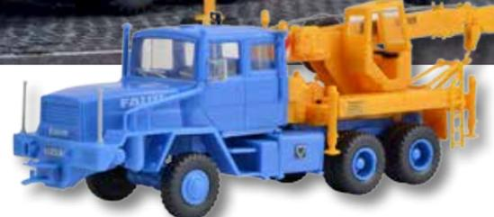
*Voll beweglicher Bergekrane auf schwerem FAUN HZ-Fahrgestell. Vorbilddaten: FAUN HZ 36.40/45, 365 PS/268 KW Diesel-motor, BILSTEIN Bergekrane, K12500H vollhydraulisch, max. Tragkraft 12 t, Hubhöhe ca. 11 m.*
