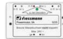
Für maximale Schaltleistung von Digitaldecodern mit separater Spannungseinspeisung und zum Anschluss an die Decoder Art. 5211, 5231, 5280 und Digitalsignale. Ein Powermodul reicht zur Versorgung mehrerer Decoder, bis zu 200 LED-Leuchten. Belastbarkeit: 5A. Gegen Überlast geschützt, eine grüne LED zeigt die Betriebsbereitschaft an.
