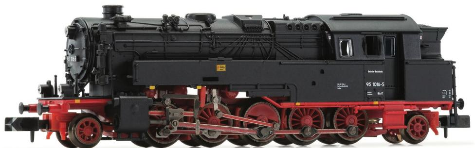
Die 95 1016-5 war nach dem Rückbau von Öl- auf Kohlefeuerung 1982 bis 1992 beim Bw Kamenz als Heizlokomotive im Einsatz.
