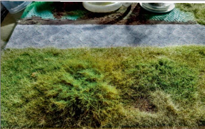
Die Verstrachung (linke untere Bildseite) ist aus insgesamt elf Faserschichten aufgebaut, die nacheinander Schicht für Schicht aufgebracht wurden.
