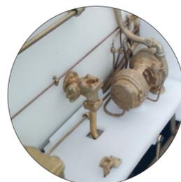
Hochpräzise ausgeführt: Speiseventil und Lichtmaschine
