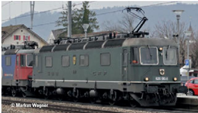
**Modèle réel :** Locomotive électrique lourde Re 6/6 en tant que Re 620 des Chemins de fer fédéraux suisses (CFF), division CFF Cargo. Version en livrée de base vert sapin. Lampes frontales rondes, prises de courant UIC, barres de maintien frontales inclinées, trappe de maintenance sur l'un des côtés de la locomotive pour la climatisation.
